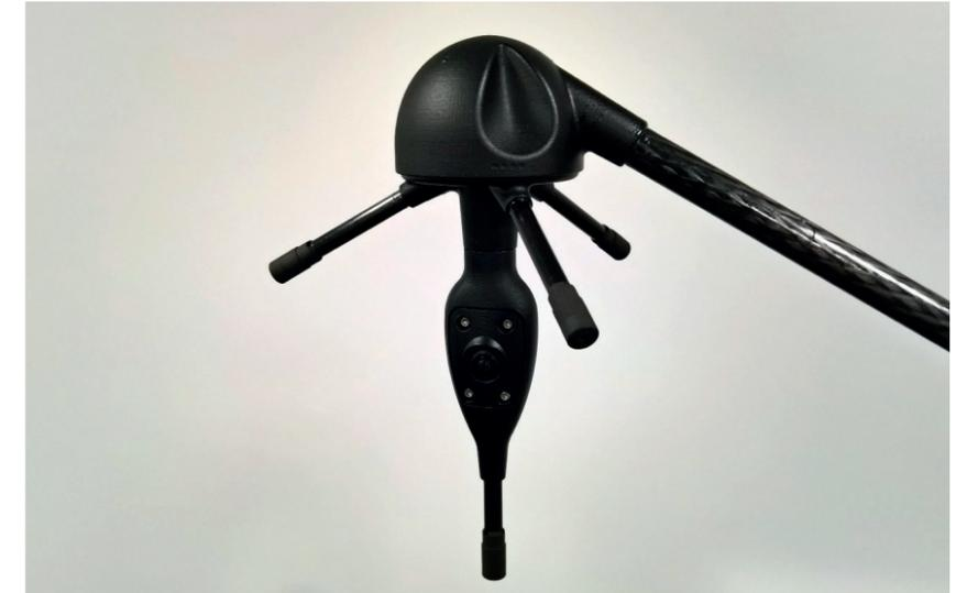
Le concept est simple : un réseau de 4 micros permet non seulement de mesurer et d'analyser les niveaux et les composantes du bruit, mais aussi de connaître précisément leurs provenances sur 360° en azimut et en hauteur avec une résolution de l'ordre du degré.
