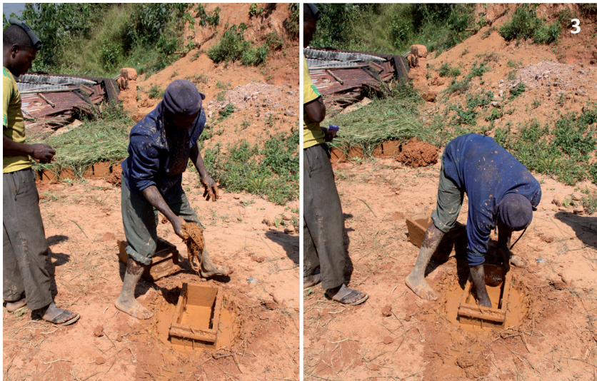
1 : Chantier de collecte de terre pour la construction de briques en terre séchée ; 2, 3, 4 : Utilisation de moules en bois pour la fabrication de briques séchées
