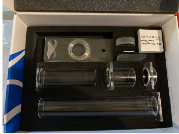
Figure 8 : microscope inversé et kit Utermöhl avec lame support et différentes colonnes de sédimentation
