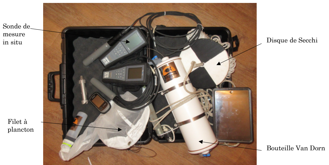
Figure 6 : Matériel de prélèvement
