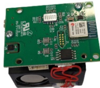
Prototype du capteur SMILE original (60 x 60 mm)
