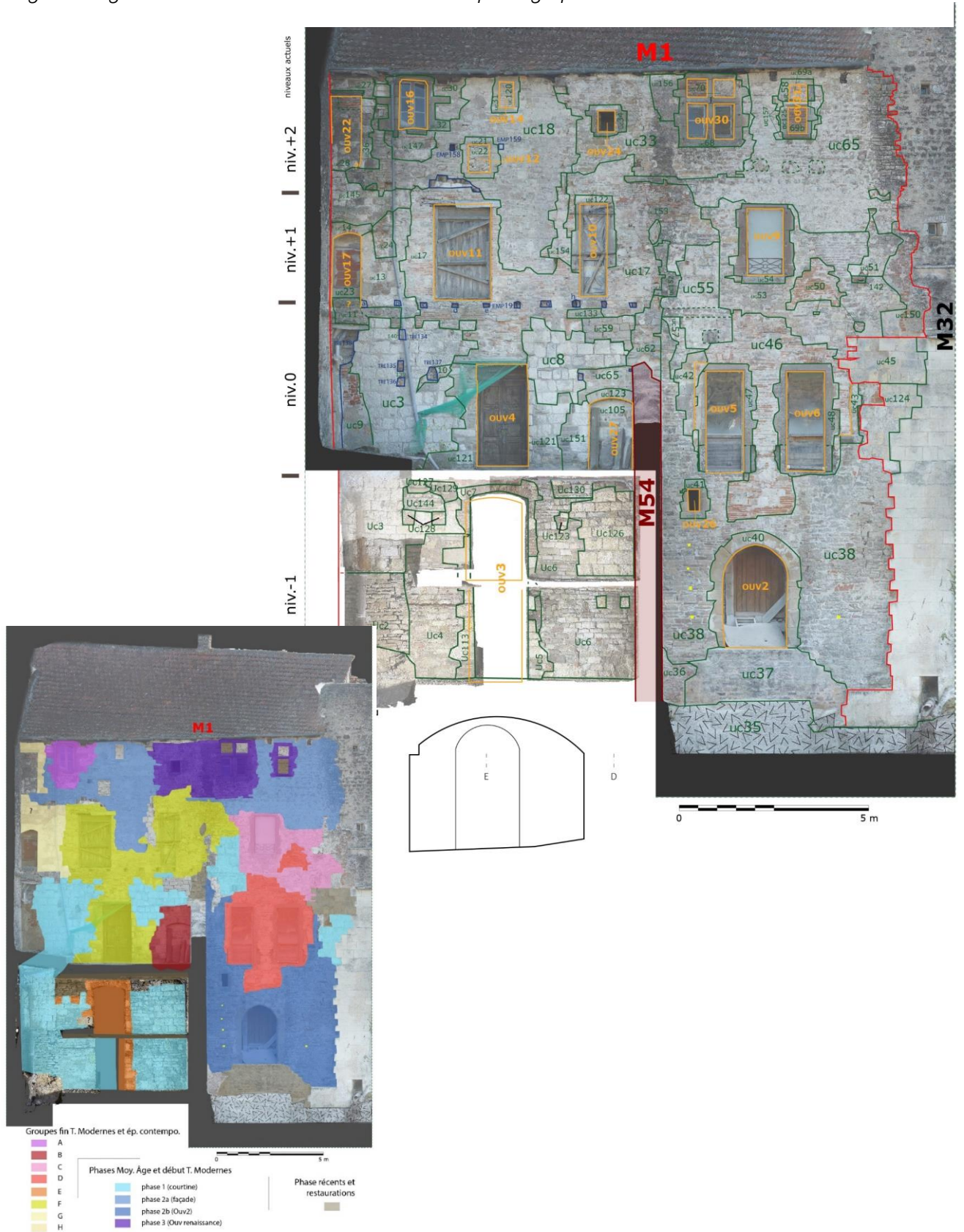
Fig. Phasage et Uc M1 externe. F. Guillot sur orthophotographies de Pascal Robert-Cols et F. Guillot
