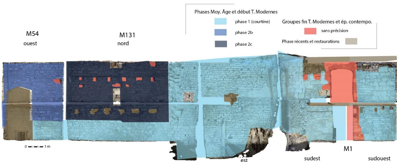
Fig. Phase niveau -1 de la maison Cordier, face interne. Crédit F. Guillot
