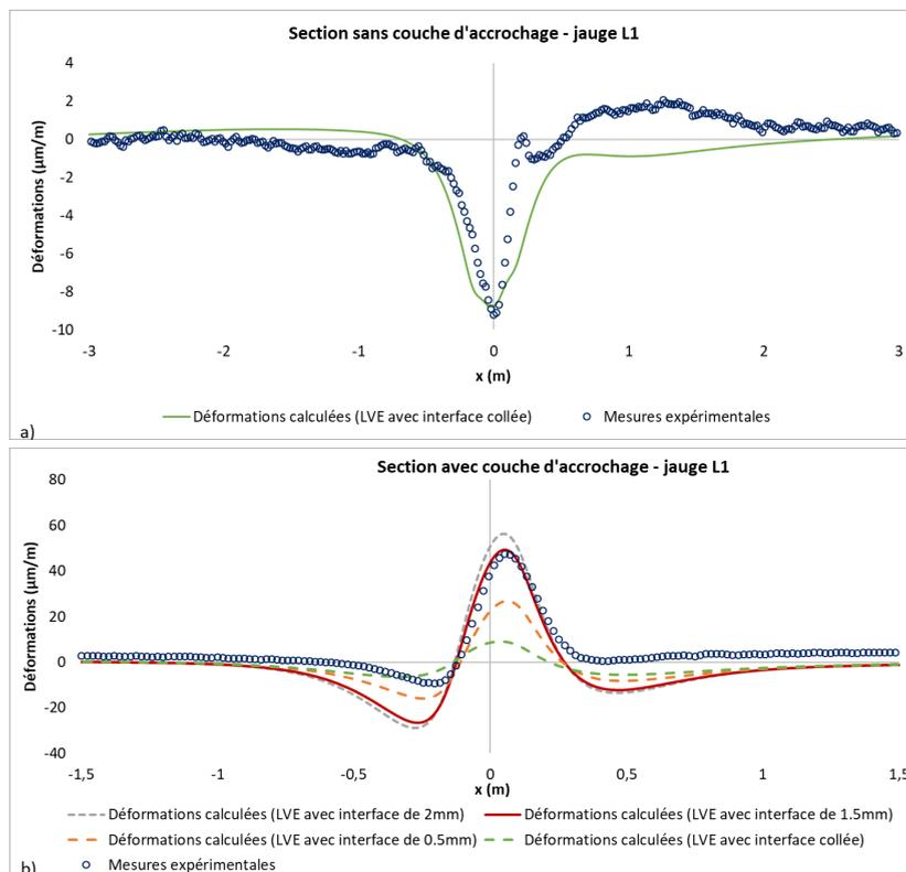
**FIGURE 6.** Comparaison entre les déformations longitudinales calculées et mesurées : a) dans la section sans couche d'accrochage à l'interface des deux couches bitumineuses) ; b) dans la section avec couche d'accrochage
