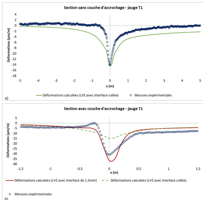
**FIGURE 7.** Comparaison entre les déformations transversales calculées et mesurées : a) dans la section sans couche d'accrochage à l'interface des deux couches bitumineuses ; b) dans la section avec couche d'accrochage
