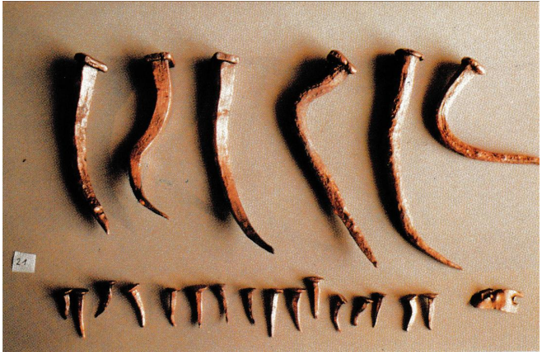
Figure 20 – Clous de charpente (en haut) et clous de doublage (en bas) après traitement de conservation.
