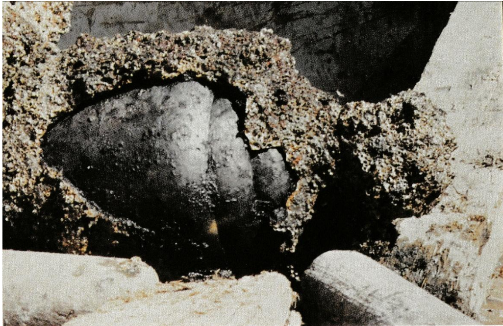
Figure 33 - Détail de la partie arrière au moment de son dépôt au laboratoire, de Komm el Dikka, montrant les trois bourellets caractéristiques des caronades anglaises.
