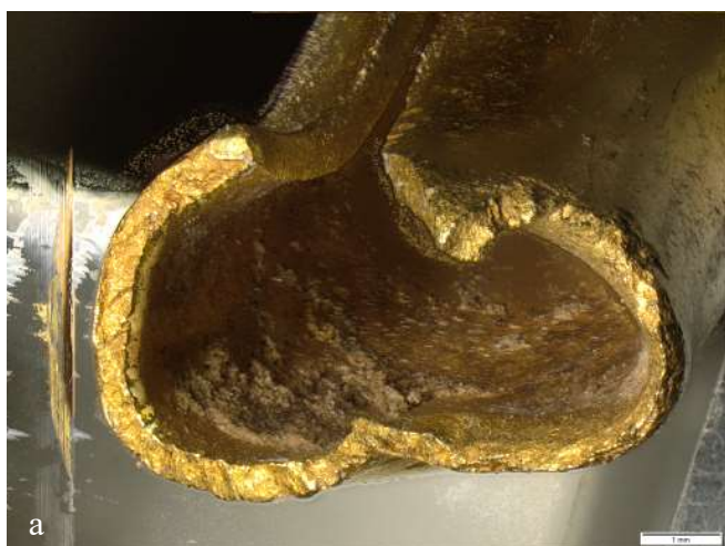
Fig. 4. Section du jonc tubulaire, aujourd'hui déformé en ovale, gauche rupture, droite coupure lisse.
