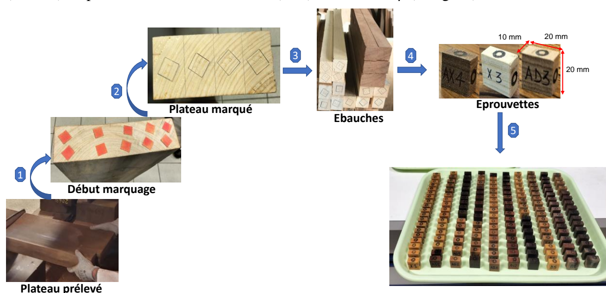
Fig. 1 : Préparation des éprouvettes d'essai
