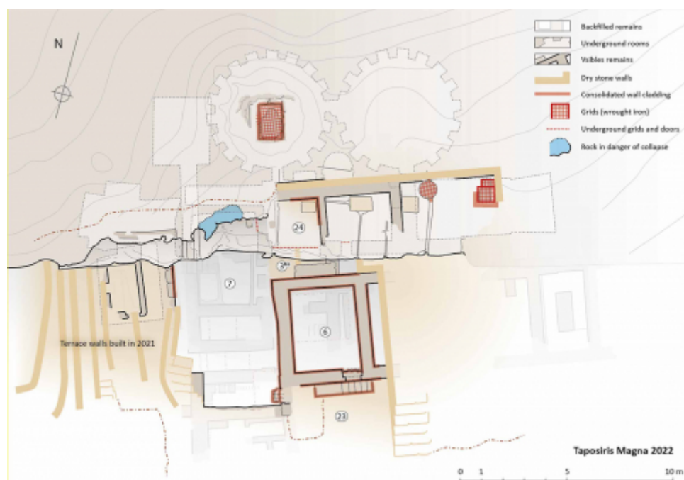
Fig. 18. Les bains ptolémaïques de Taposiris Magna, localisation des principaux travaux de restauration (MFTMP, T. Fournet).
