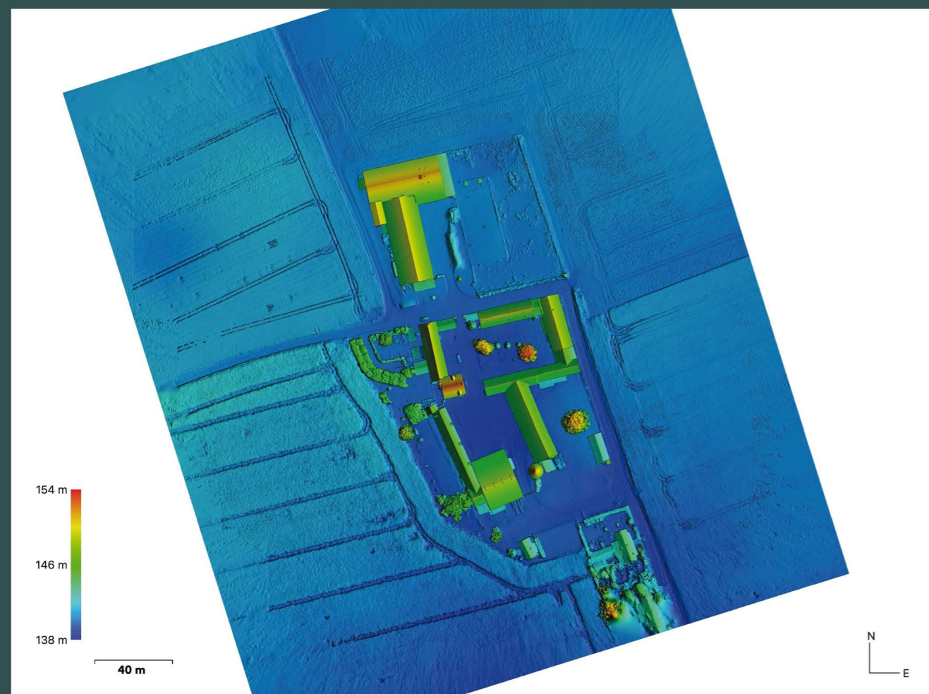
Figure 01. Ferme du Mesnil, prospection aérienne par drone, modèle numérique d'élévation reconstruit, densité des points 61,6 m 2 (P. Kervella, ARBR)
