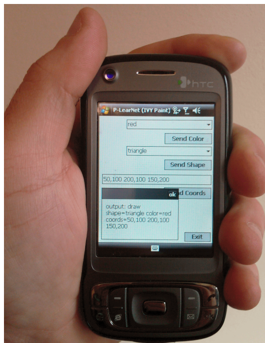
Figure 27 : Utilisation d'un smartphone HTC pour communiquer avec le bus IVY, via le délégué
