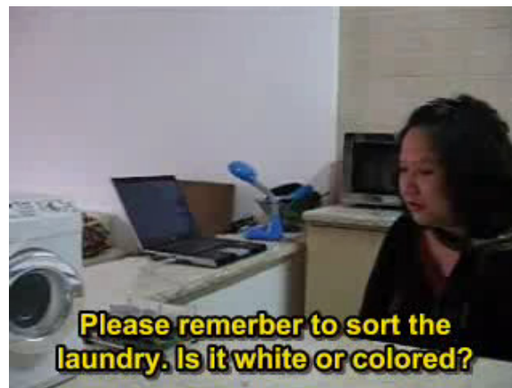
Figure 43 : La machine à laver interroge oralement l'utilisateur à propos du type de linge à laver
