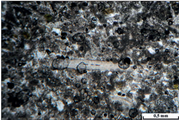
Fig. IX.1-14 - Calcaire R4 vu en lumière polarisée non analysée au microscope polarisant © Cliché A. Polinski.
