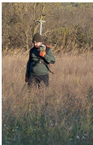
Illustration i : Prospection électromagnétique à l'EC38-MK2 ( Geonics Ltd ). Cliché : Corinne Sanchez.
