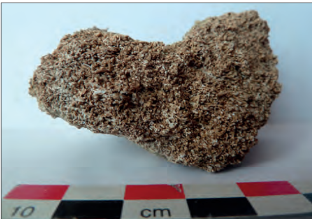
Fig. IX.1-11 - Aspect macroscopique du calcaire R3 © Cliché A. Polinski.
