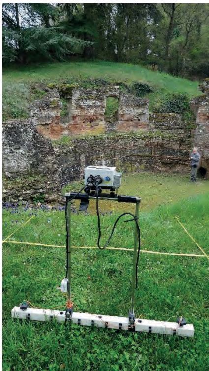
Illustration ii : Châssis du résistivimètre RM85 (Geoscan Research) avec deux électrodes et deux autres positionnées à l'infini. Cliché : Guillaume Bruniaux.
