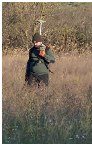
Illustration i : Prospection électromagnétique à l'EM38-MK2 (Geonics Ltd). Cliché : Corinne Sanchez.
