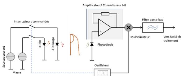
Fig 2 : Modèle du système de détection pour la mesure du CO<sub>2</sub> (adapté du système Microchip AN1525 [12]).
