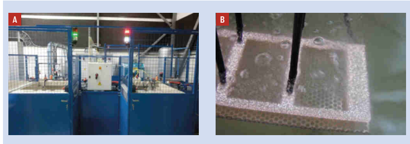
FIGURE 3 : A) Installation de production de la société GIT : 2 cuves de 1000 L, 3 générateurs de courant de 250 A. B) Traitement d'OMA. Les micro-arcs sont les points blanc visibles à la surface de la pièce.
