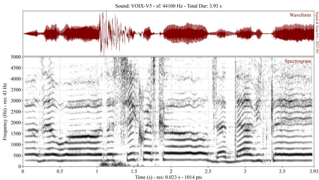
**Figure 9 – Spectrogramme de la voix V5 (« Hallelujah » de L. Cohen, 1ere phrase). Mise en évidence des zones d'ombre dans les harmoniques à partir de 1500 Hz et des transitoires d'attaque et de fin bruyants marqués par des zones verticales de brouillard. (Du début à 3,5 s.)**
