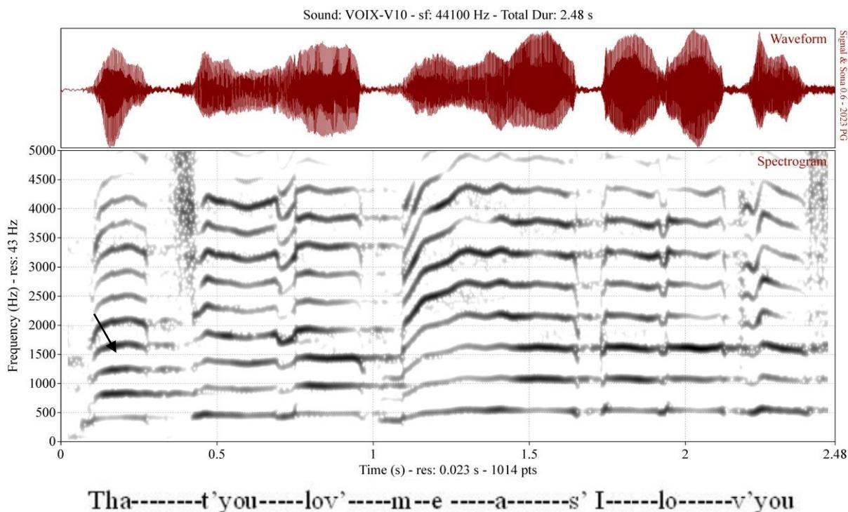
**Figure 14 – Spectrogramme et enveloppe d'amplitude de la voix V10 (« How High The Moon », N. Hamilton et M. Lewis). Mise en évidence de la puissance et du renfort d'énergie dans les harmoniques de rang élevé, et de la franchise des transitoires**
