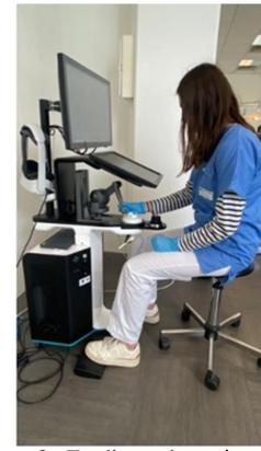
Figure 3. Etudiant s'entraînant en environnement non immersif sur VirTeaSy Dental®
