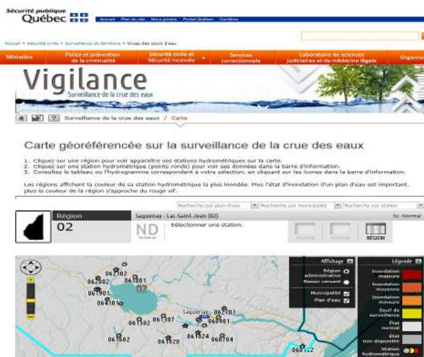
Figure 20 : Système Vigilance de surveillance des débits aux stations hydrométriques
