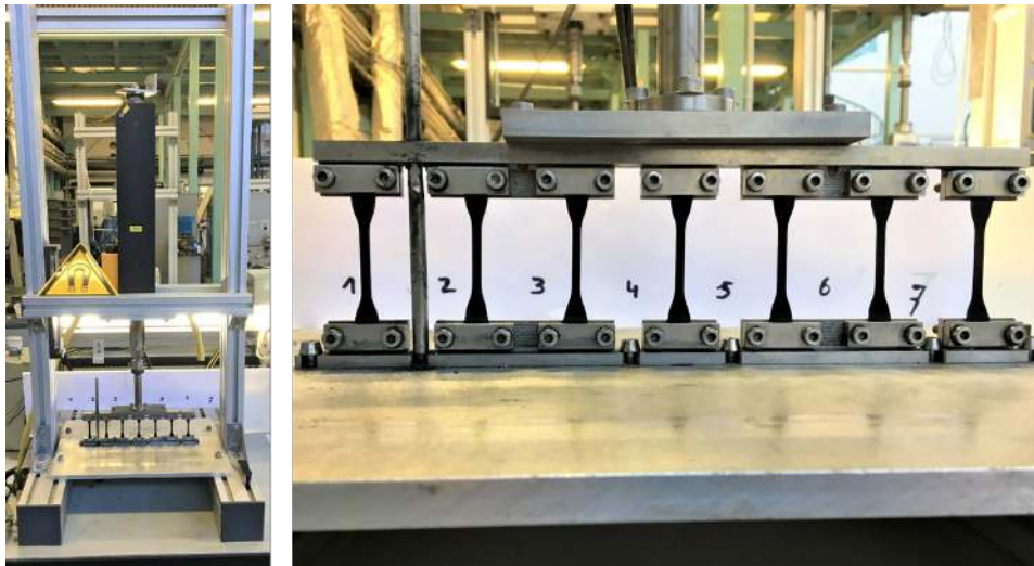
FIGURE 1 – Montage expérimental de fatigue sur vérins électriques
