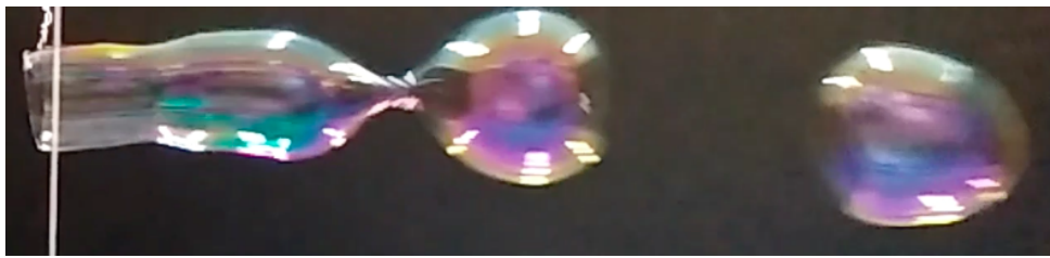
Figure 1. Photographie de la poche de savon à l'aval de laquelle des bulles se détachent de manière périodique.
