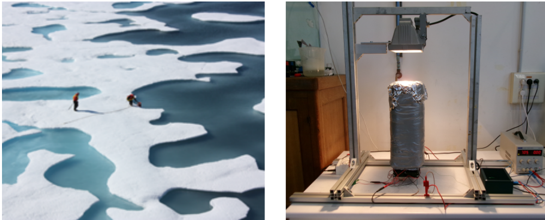
Figure 1. À gauche : Mares de fonte sur la banquise. À droite : Photo du dispositif expérimental. L'échantillon, du polyéthylène glycol ou de la paraffine initialement solide, est placé dans une cuve en verre, isolée par de la laine de verre. Une lampe halogène éclaire l'échantillon par le haut afin de le faire fondre. La température est contrôlée à la base du dispositif par des modules à effet Peltier asservis à une sonde thermocouple.
