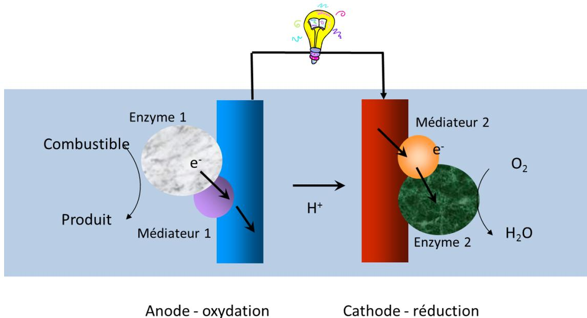
Figure 2 : Schéma simplifié d'une biopile enzymatique.
