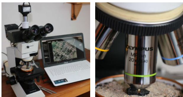
Figure 4 - Détails du microscope équipé d'un dispositif en lumière incidente (Olympus CX40 à grossissements x50 à x500) et d'une caméra numérique (Laboratoire ArkéoMap)
