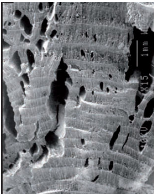
Figure 8 - Exemple de fentes de retrait (Marguerie et al., 2010)
