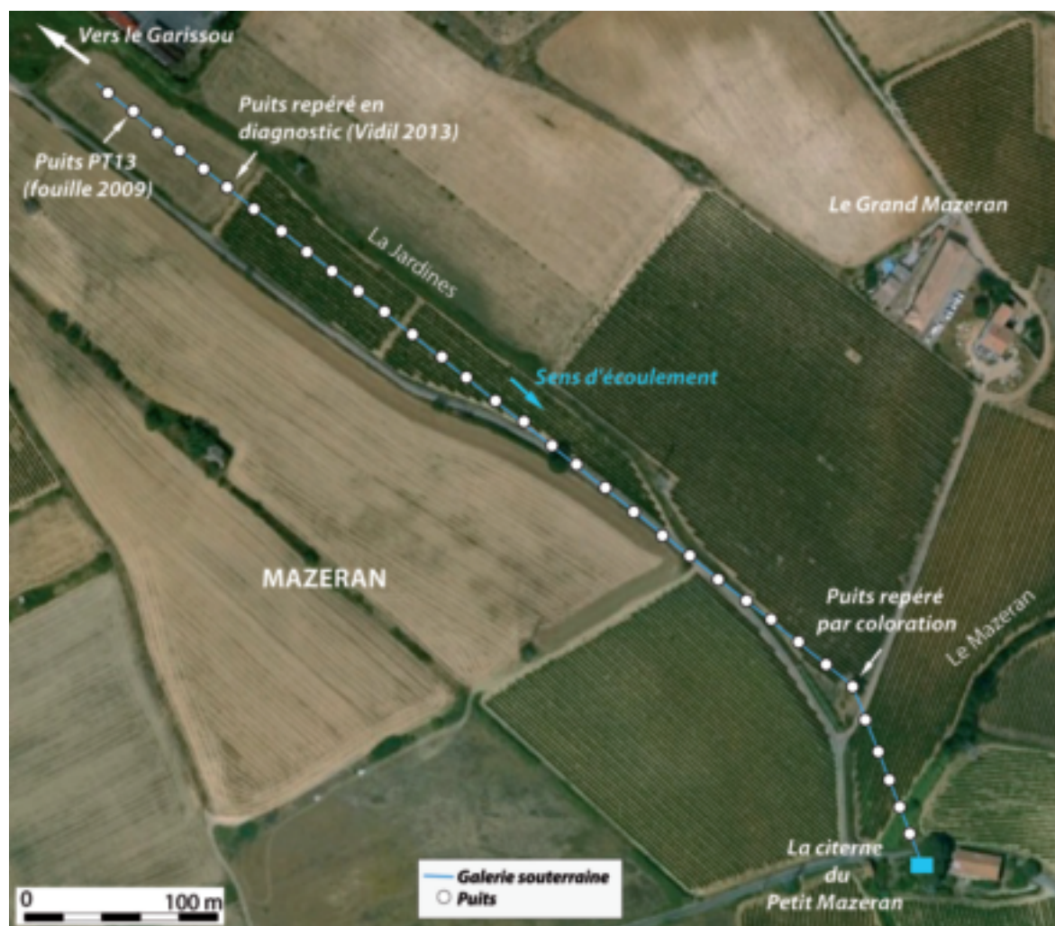
Figure 13 : restitution hypothétique du tracé du qanât romain de Mazeran. DAO : R. Haurillon.
