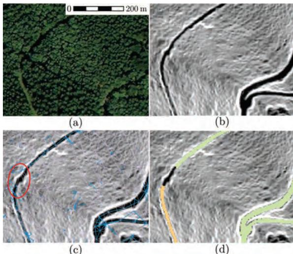
**FIGURE 5** : Illustration du manque d'exhaustivité locale dans la détection. (a) Orthoimage. (b) Carte de pente  $\mathcal{P}$ . (c) Graphe avant et après élagage (respectivement en rose et bleu). (d) Résultat final (code couleur identique à la figure 3).
