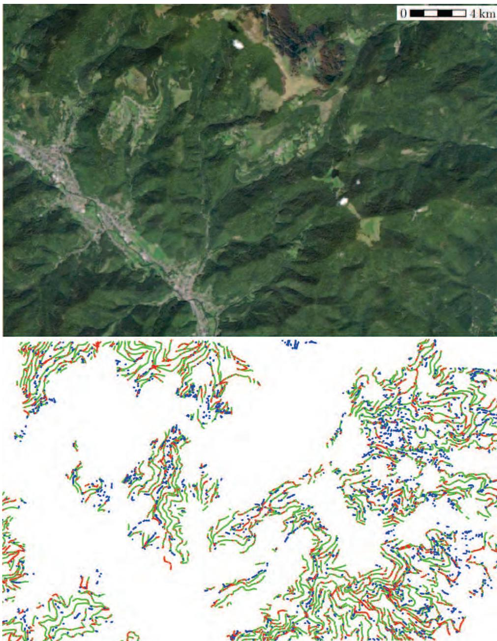
**FIGURE 8** : Résultats d'évaluation de la détection de routes sur la zone du Grand Ballon : rayon buffer = 5 m, longueur minimale = 3 m. Haut : orthoimage. Bas : qualification. Légende identique à la figure 7.
