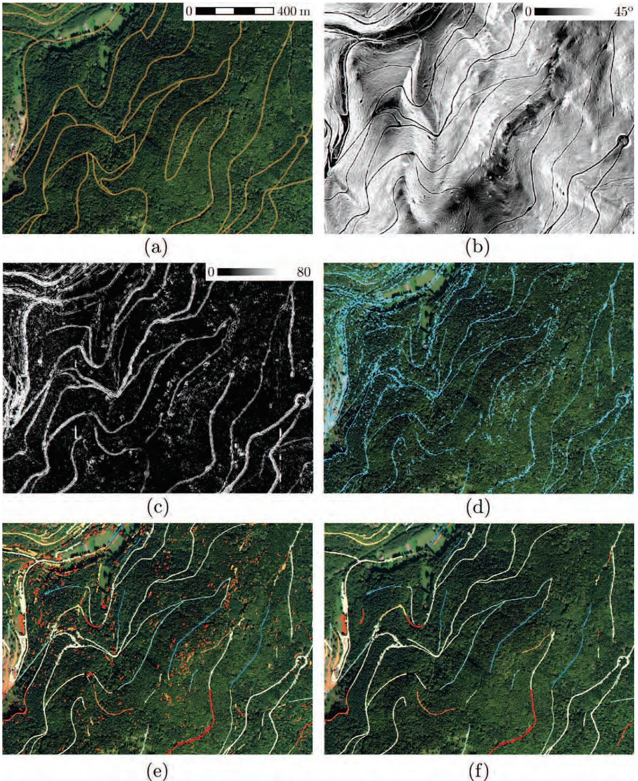
**FIGURE 3 :** Illustration de la méthode sur une zone d'intérêt. (a) Orthoimage avec une BD existante. (b) Carte de pente. (c) Carte de pente multi-échelles. (d) Graphe de route après élagage. (e-f) OBIA avant et après filtrage. Chaque segment est coloré selon sa largeur calculée par SFS (cf. Partie 2.4). ■ : < 3,5 m – ■ : 3,5-4,5 m – ■ : 4,5-5,5 m – ■ : 5,5-6,5 m – ■ : > 6,5 m.
