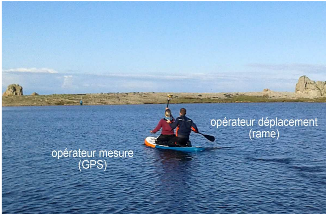
Figure 16 – Relevé topographique au paddle /DGPS de la lagune nord
