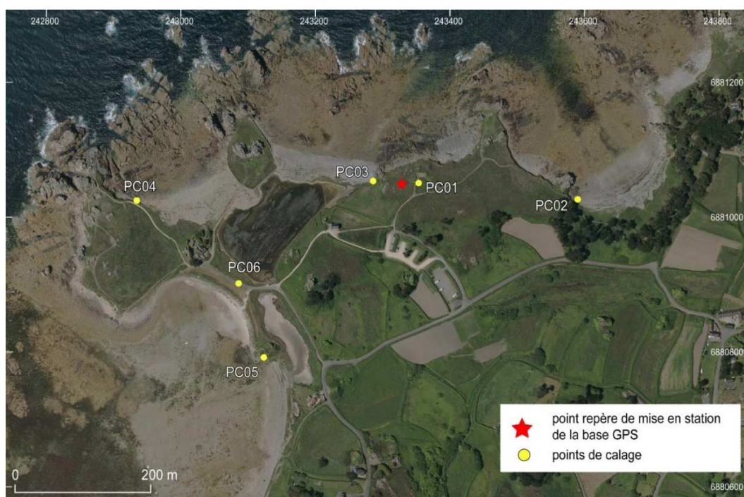
Figure 12 – Carte de localisation des points géodésiques (repère de mise en station et points de calage) sur le site du Gouffre à Plougascant.
