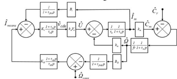
fig 7 : Schéma bloc MCC
