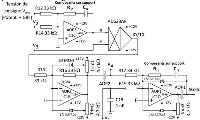
fig 5 : Schéma électronique des correcteurs
