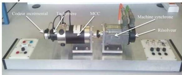
fig 9 : Vue du banc moteur
