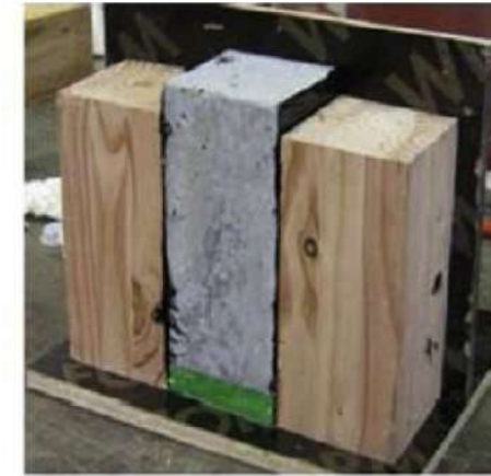
Schéma et photo d'une éprouvette Push-Out
