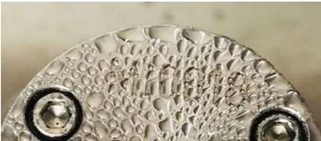
Figure 3 – goutte de condensation à la surface froide d'un corps de pompe.
