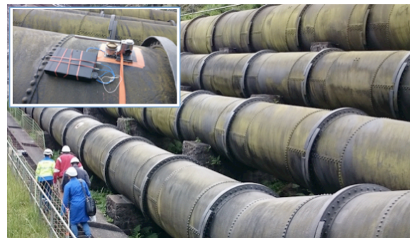
Figure 6: Caractérisation par indentation de conduites forcées
