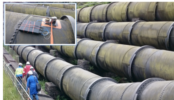
Figure 6: Caractérisation par indentation de conduites forcées
