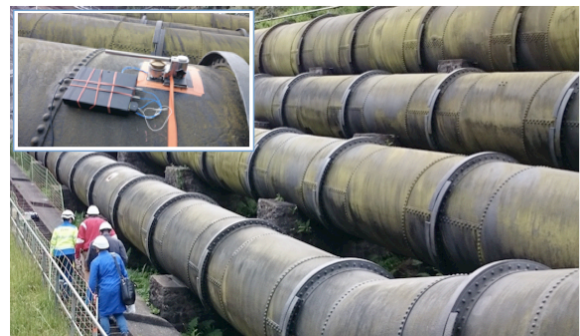
Figure 6: Caractérisation par indentation de conduites forcées
