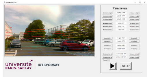
FIGURE 3 – L'application développée par les étudiants pour la mise au point des paramètres extrinsèques Vision RGB-D/LiDAR et la reprojection de données de la télémétrie sur un flot d'images.
