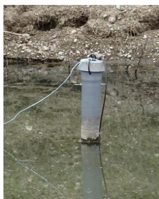
Figure 32 : Support pour la sonde construit par FNE Loire (FNE Loire, 2019)
