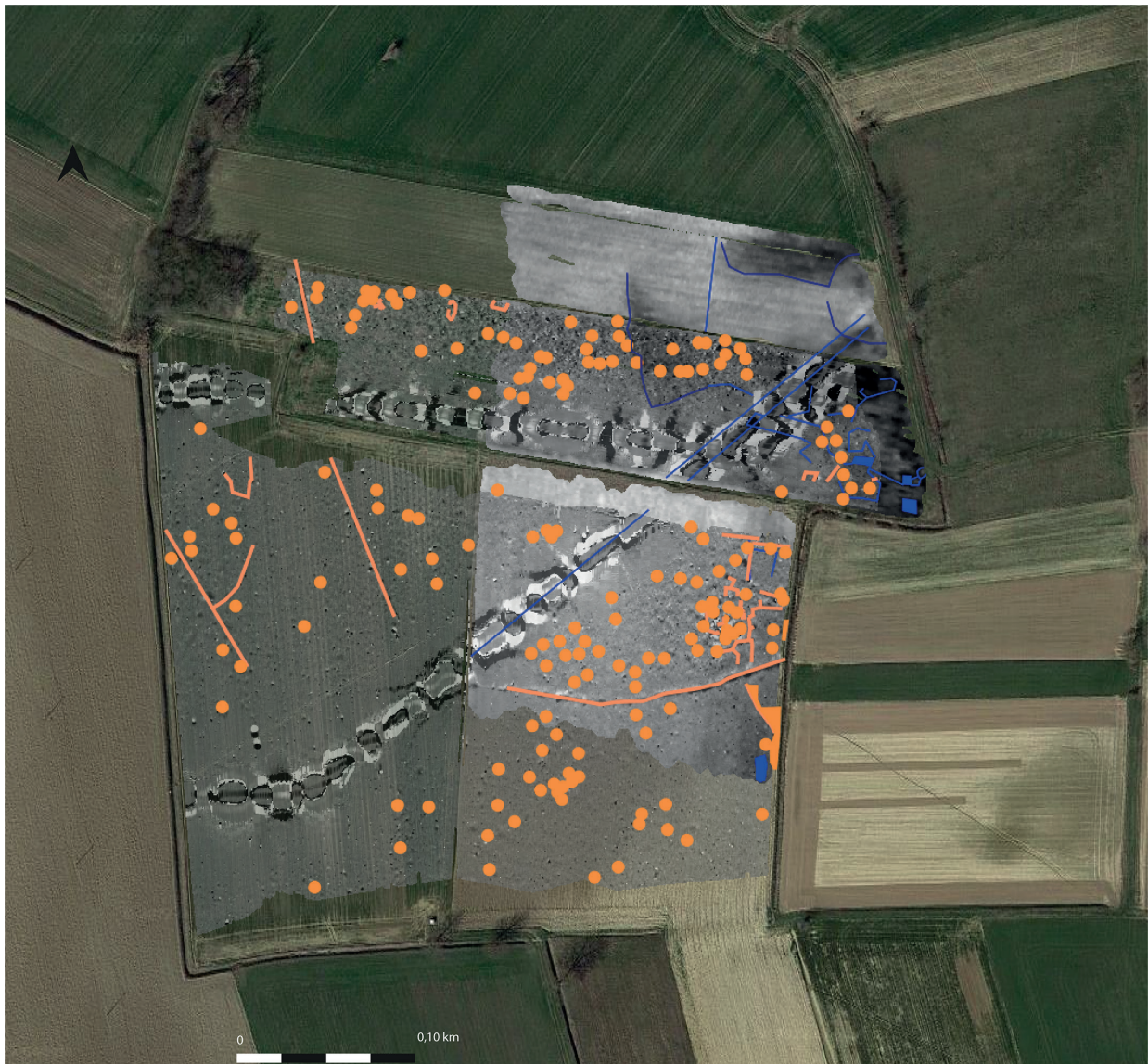
5. Carte géophysique cumulative : données AMP et ARP interprétées : anomalies linéaires, ponctuelles et surfaciques (bleu : électrique, orange : magnétique). Élaboration A. Grout, M. Dabas, V. Cicolani, fond Google, serveur Chronocarto.
