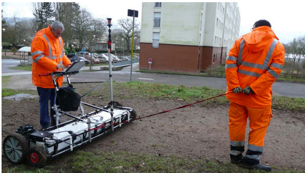
Fig. 8 – Intervention de GEOSTUDI Astier, mandaté par Géocarta, à l'aide d'un Stream-X (IDS, Italie) équipé d'une double antenne 200 MHz, acquisition géoradar réalisée en janvier 2017 (cl. Y. Labaune).
