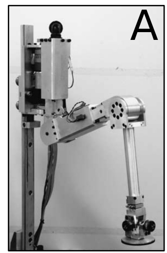
A Identification du modèle de la patte SIL04 leg . E. Garcia et al, Journal of Intelligent and Robotic Systems, 2023.
