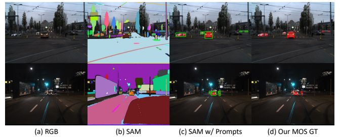
FIGURE 4 : Deux exemples DSEC-MOS [12] : (a) RVB calibrés sur événements; (b) SAM [13] direct; (c) SAM avec des boîtes englobantes de DSEC-MOD; (d) Résultats de segmentation DSEC-MOS, visualisées en rouge sur les images RVB.
