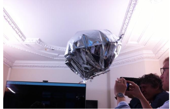
Lors de cette réunion, Jean-Baptiste Mouret, spécialiste de la robotique à l'INRIA 213 Strasbourg, présentait, en vue d'une possible exploration, un prototype de dirigeable gonflable pouvant être introduit dans une cavité à travers un forage de 3cm de diamètre.
