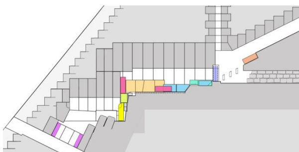
Vue de la maçonnerie posée sur la Herse. Les deux blocs ne sont pas alignés à cause des conditions de leur pose.
