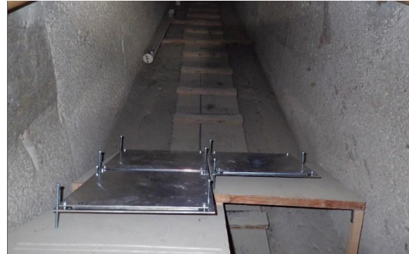
Photo de plaques à émulsions test posées dans le couloir descendant lors des missions de janvier à avril 2016.
