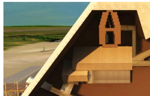
Version de « Kheops Renaissance » révélée en 2011. Le passage du sarcophage de la première à la seconde chambre LONGITUDINALEMENT imposait que le sol de la seconde soit au niveau de la Pierre de Strabon. Celle-ci devait être stockée en fond de chambre pour laisser le passage à la procession funéraire et pour être poussée jusque sous les chevrons. La rampe intérieure était un peu moins bien centrée sur la seconde chambre.
