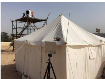
Vue de la tente positionnée à 175 m de la face Nord, de la caméra infrarouge et de la plaque de calibration installée dans le champ de vision de celle-ci.
