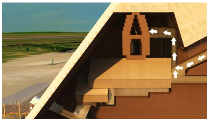
Le puits d'évacuation des derniers ouvriers ayant scellé la pyramide de l'intérieur : quelques mètres à parcourir pour rejoindre la rampe intérieure et quitter le monument en toute simplicité.
