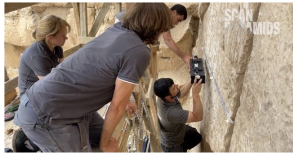
Acquisition de données avec l'ultrason.
