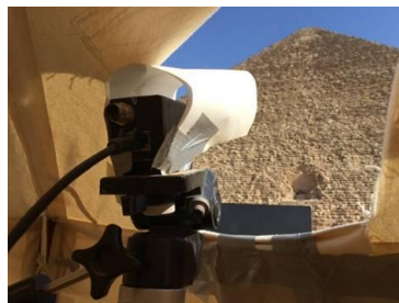
Vue de la tente positionnée à 175 m de la face Nord, de la caméra infrarouge et de la plaque de calibration installée dans le champ de vision de celle-ci.
