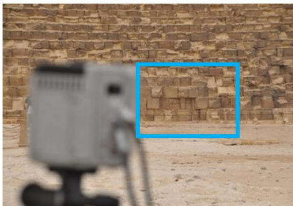
Position de la caméra microbolomètre à 50m de la face Est. L'anomalie détectée est à l'intérieur du rectangle bleu.
