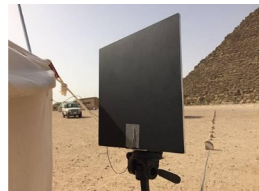
Vue de la tente positionnée à 175 m de la face Nord, de la caméra infrarouge et de la plaque de calibration installée dans le champ de vision de celle-ci.
