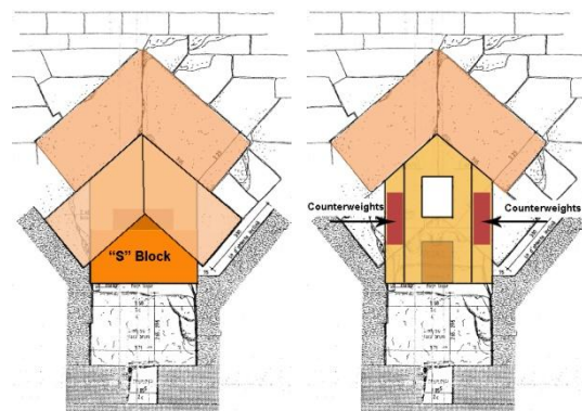
Scellement de l'accès au Circuit Noble après les funérailles : 2 ème opération.
