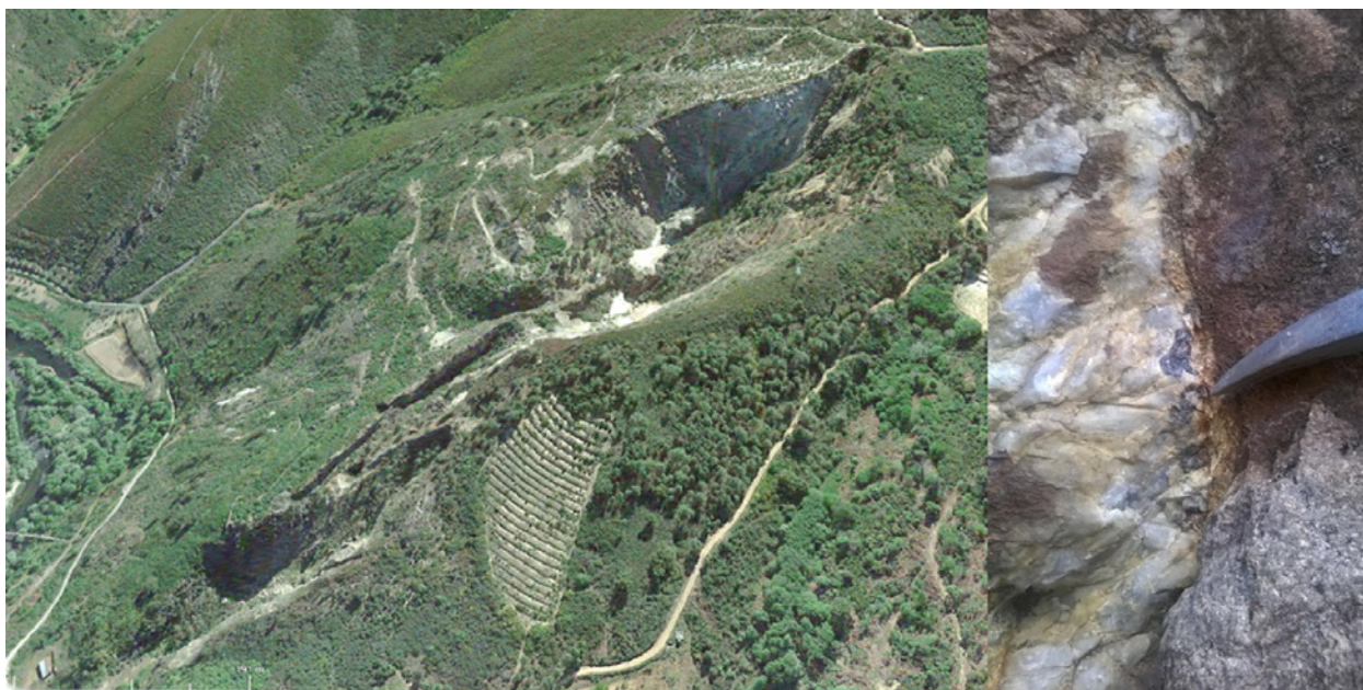
Figura 6 - À esquerda, imagem do Google Earth do estado actual da cratera deixada pela exploração do séc. XX da mina do Tuela (Ervedosa). À direita identificação de um filão de quartzo com cassiterite pela equipa durante o trabalho de campo.
