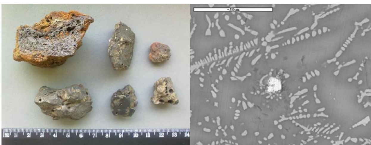
Figura 3 - À esquerda materiais estudados do Castro de Carvalhelhos, que incluem (de cima para baixo, da esquerda para a direita) uma escória de ferro, dois fragmentos cerâmicos/argamassas de revestimento de forno/fornalha metalúrgico/a e três fragmentos de escórias de estanho. À direita uma microestrutura de uma das escórias de estanho (imagem BSE, de SEM-EDS, escala 50 mm), onde são visíveis estruturas dendríticas numa matriz vítrea e ao centro uma inclusão de estanho metálico (a branco).
