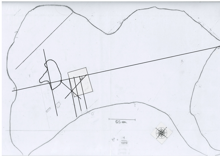
FIGURE 22 – Utilisation d’une grande ligne et de perpendiculaires pour repérer les bâtiments.
