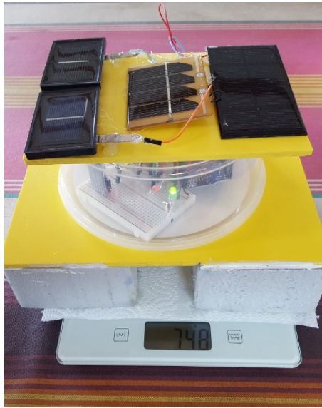
FIGURE 29 – Pesée du prototype de balise conçu en technologie
