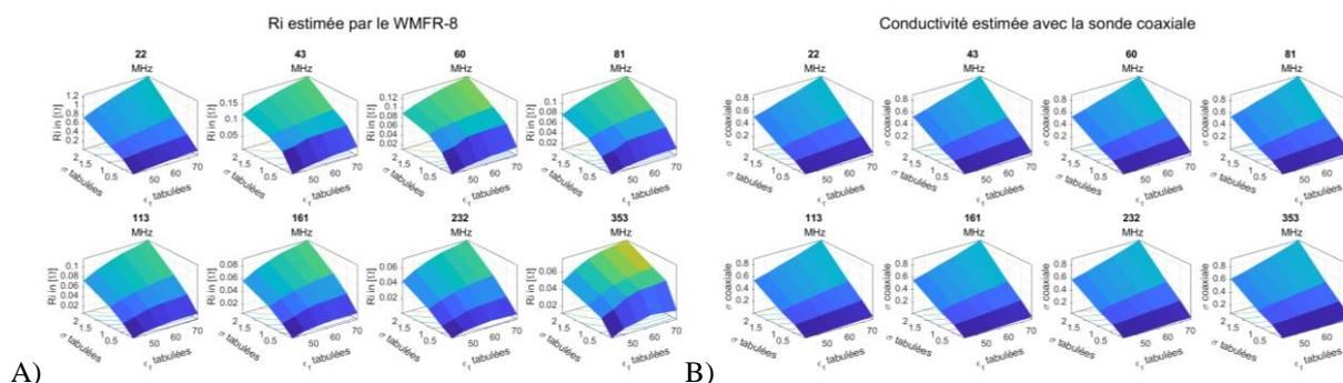
**Figure 2.** A) Evolution de  $R_i$  estimée par le WMFR-8 et B) Evolution des valeurs de la conductivité estimée par la sonde coaxiale, en fonction de la conductivité et la permittivité tabulées des solutions de références.
