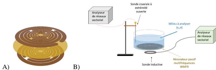
**Figure 1.** A) Structure du WMFR utilisé à 8 résonateurs. B) Schéma de l'expérience mettant en œuvre une sonde coaxiale plongée dans le liquide et un capteur sans contact WMFR placé sous le cristallin.
