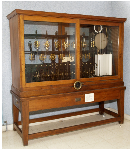
Figure 7 : Le prédicteur de marée du S.H.O.M. à Brest, construit par Kelvin-Bottomley en 1924 sous le nom de TP n°6.
