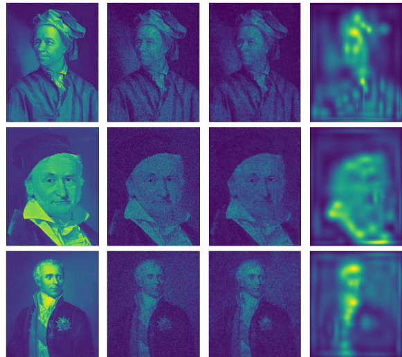
FIG. 4: Un FSD (3ème col.) peut approcher la distribution associée à une image (1ère col.) à partir d'échantillons (2ème col.) - comparé à un MG obtenu via EM (4ème col.).
