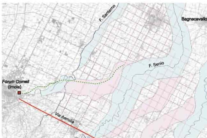
Fig. 16: indicativo tracciato dell'asse stradale Forum Corneli-Ravenna lungo il Santerno di età romana, con ubicazione del tratto di glareata obliqua rinvenuto a nord-est di Imola. Si noti che la strada doveva correre sul culmine del paleodosso fluviale del Santerno attivo in età romana, raffigurato in rosa.
