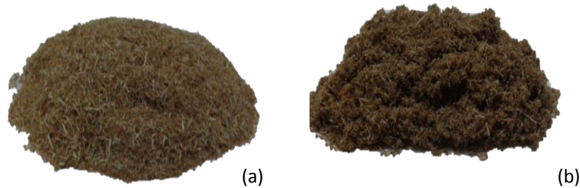
Figure 1 : Pétiole de bois de palmier broyé (a) Fibres Brutes (b) Fibres Traitées
