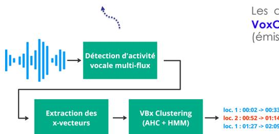
Fig. 3 : Schéma complet du système de diarisation utilisé
