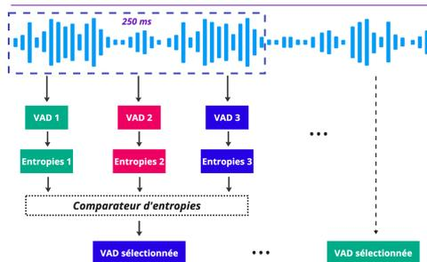
Fig. 2 : Schéma de la détection d'activité vocale multi-flux
