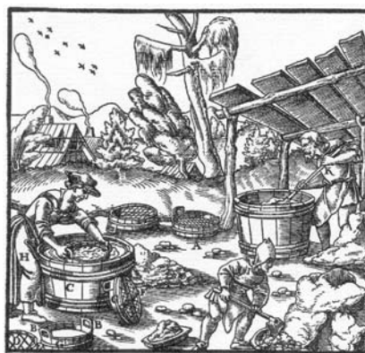
A : Tamis rond B : Ses anses C : Baquet D : Fond d'un tamis fait en fils de fer E : Le cercle qui retient ceux-ci F : Les cercles G : Cercle du tamis H : Femme agitant le crible I : Jeune homme préparant les matières à laver K : L'homme va enlever à la pelle les matières qui ont passé à travers le crible
