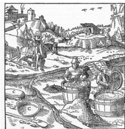
A : Les corbeilles B : Leurs anses C : Plateau D : Sa partie arrière E : Sa partie avant F : Ses anses
